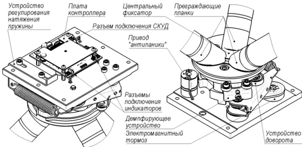
**Рис.5** Механизм турникета (вид верхней и нижней части)
