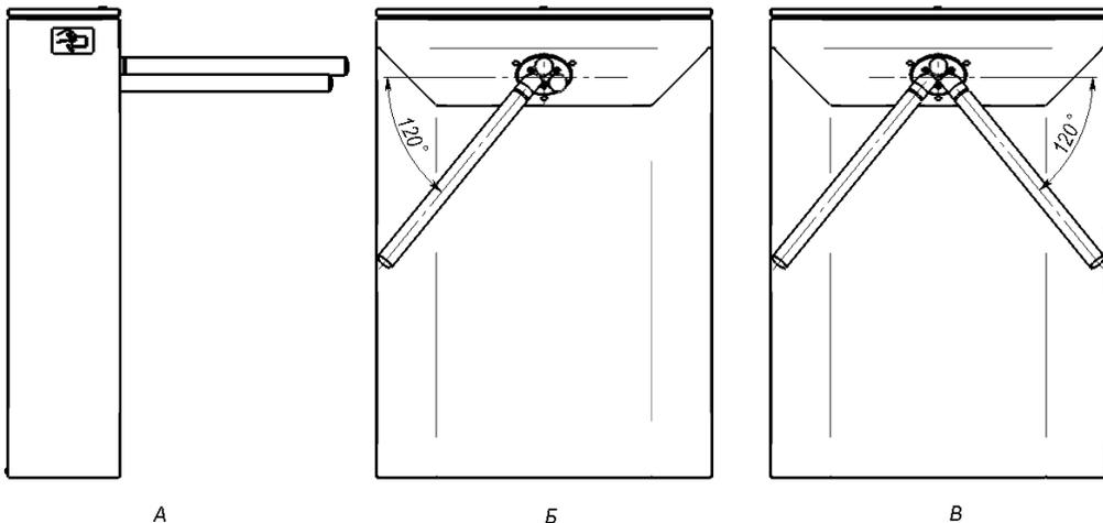
**Рис.4** Установка преграждающих планок в исходное рабочее положение
