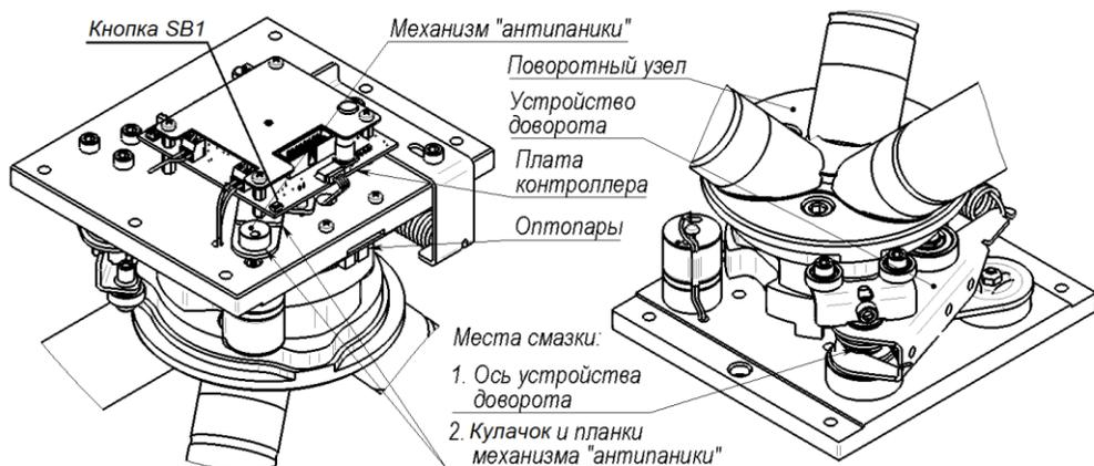
**Рис.7** Расположение узлов и деталей трения. Места смазки
